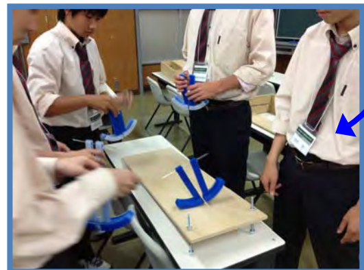
図3 「受動歩行ロボットキット」を各自が製作して歩行実験! (はじめはほとんど歩行しなかった)
